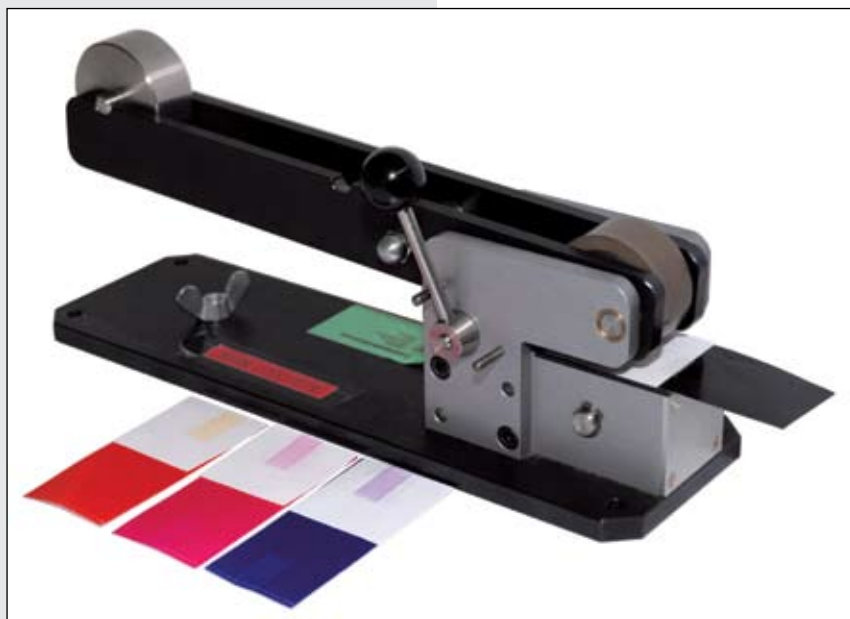
Rys. Urządzenie do badania karbonizacji MHM
