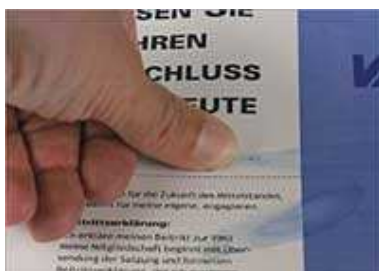
Rys. Ograniczona zdolność do wchłaniania olejów farb offsetowych przez papiery niepowlekanie wydłuża proces ich schnięcia.
