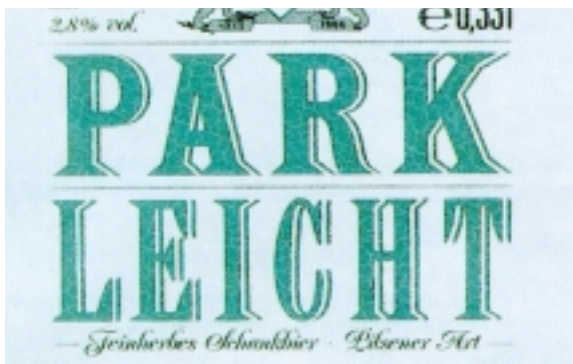
Rys. 13. Pęknięcie warstewki lakieru po wyschnięciu.
